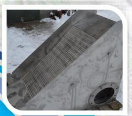
Bei der Firma Stocker Technik GmbH, welche unter anderem Kleinwasserkraftwerke im alpinen Raum realisiert, werden zur Wasserfassung "QWehr-Rechen" eingesetzt.
